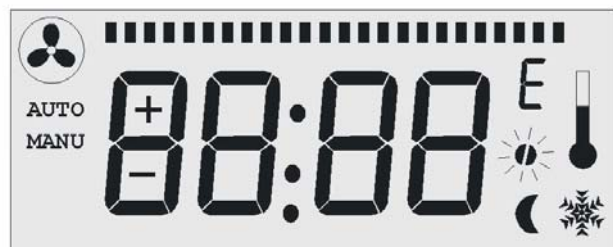
Fig. 3. Test LCD après mise sous tension
